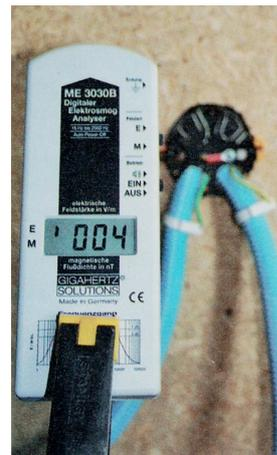
En utilisant des gaines et des boîtiers blindés reliés à la terre, les émissions sont réduites à 4 V/m !...
